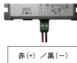
DCハーネスを使用した接続時
