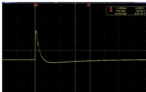
PW936C-5V1A 無 雷サージ (2kV) を印加時 1,542V
